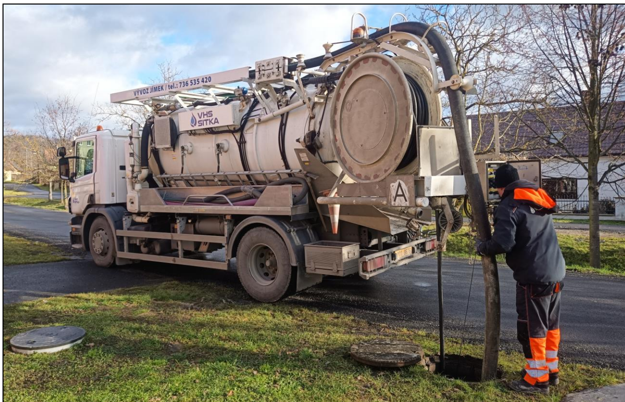
Čištění kanalizace vlastní technikou – kanalizační stroj Kroll na podvozku Scania (Plinkout, leden 2023).
